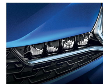
Светодиодные фары MFR с многофокусными отражателями
