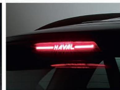
Дополнительный светодиодный стоп-сигнал
