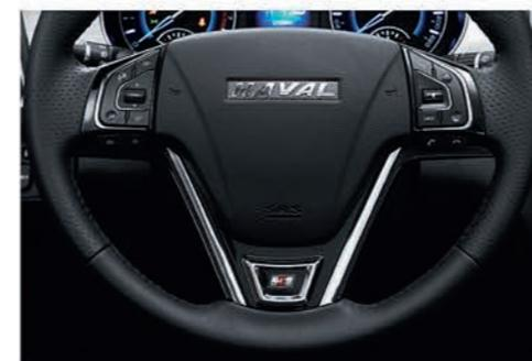
② Клавиши управления на рулевом колесе
